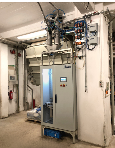
Vakuumfördersystem, Anschluss mehrerer Probenleitungen
